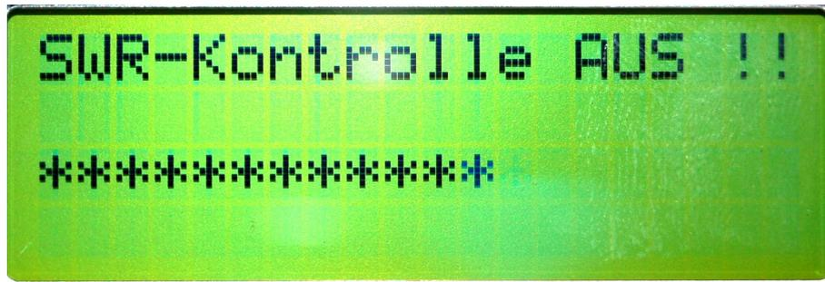
Abbildung 3.7: Ansicht der LCD-Anzeige: Während des Drückens des RESET-Tasters.
