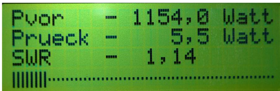
Abbildung 3.15: Die Ansicht des externe Wattmeters beim Senden.
