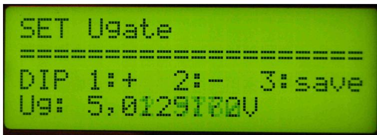
Abbildung 3.11: Mit den DIP 1,2 wird eingestellt und mit DIP 3 das Resultat abgespeichert.
