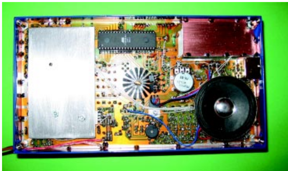
Z lewej strony widoczny radiator tranzystora mocy
